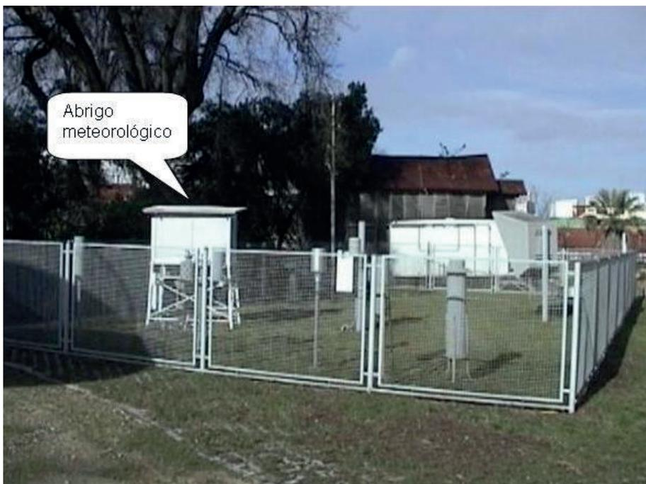
**Figura 6.11:** Abrigo meteorológico da estação meteorológica do IGIDL | **pág. 227.**
